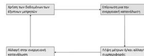
Σχήμα 1. Σχηματική αναπαράσταση του τρόπου με τον οποίο η χρήση των έξυπνων μετρητών μπορεί να οδηγήσει σε μείωση της ενεργειακής κατανάλωσης.
